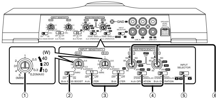
Ceci est un amplificateur à 4 canaux avec deux amplificateurs stéréophoniques en un élément; l'un appelé Amplificateur A, l'autre Amplificateur B. Cet appareil est compatible avec diverses configurations de chaîne, simplement en sélectionnant les positions des commutateurs et les fonctions comme indiqué ci-après.
