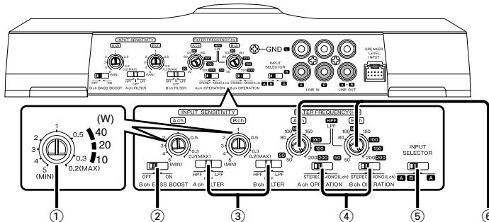
Este es un amplificador de 4 canales con dos amplificadores estéreo en un mismo cuerpo. Uno de los amplificadores recibe el nombre amplificador A y el otro el de amplificador B. Combinando los conmutadores y las funciones descritas a continuación, esta unidad amplificadora es compatible con una amplia gama de sistemas.
